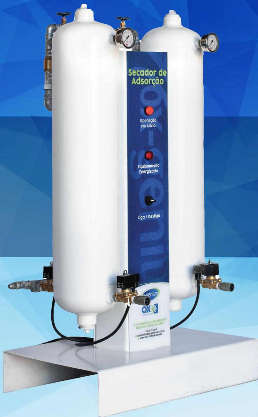
O processo de secagem de ar comprimido pelo princípio físico da adsorção é de elevado rendimento, aliando alta eficiência e confiabilidade. Os materiais de adsorção são regenerados a frio depois de alcançada sua saturação. Com relação ao ar comprimido, o sistema de adsorção permite eliminar o vapor d'água presente na mistura permitindo obter pontos de orvalho próximos de  $-100^{\circ}\text{C}$ .
